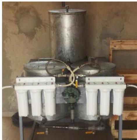
Après cela, une seconde opération de décantation est faite pour débraser cette huile des impuretés après décantation. La réduction de la teneur en aflatoxine et des impuretés est faite par un système de filtrage à travers l'utilisation d'un micro unité de filtrage mise au point par l'Institut de Technologie Alimentaire (ITA). L'utilisation d'argile (attapulгите) permet de réduire les aflatoxines et rendre l'huile plus claire.
